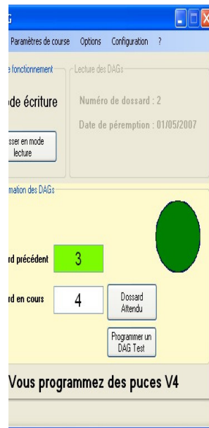
Illustration 17: Écriture de la puce OK : la puce est alors programmée comme étant le dossard 3.
